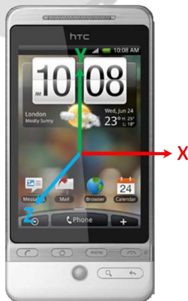
圖 3.3、手機三軸加速度感測器示意圖。
